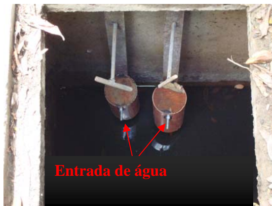
Figura 3. Vista superior do poço de visita com duas garrafas coletoras instaladas, observando-se os parafusos confeccionados para fixar a haste a parede.
