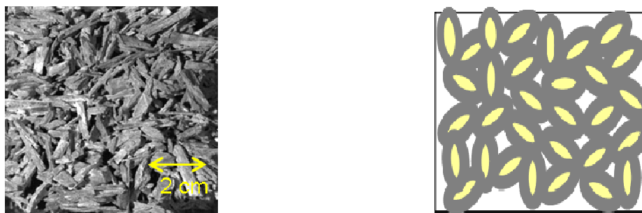
Fig. 1 : Aspect général du béton de granulat de bois par une caméra optique et schéma de modélisation
