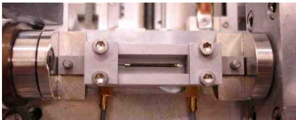
Figure 3 : Eprouvette montée dans la machine in-situ
