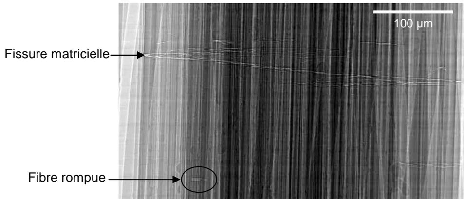
Figure 16 : Extrait d'une radiographie du minicomposite à 92 N
